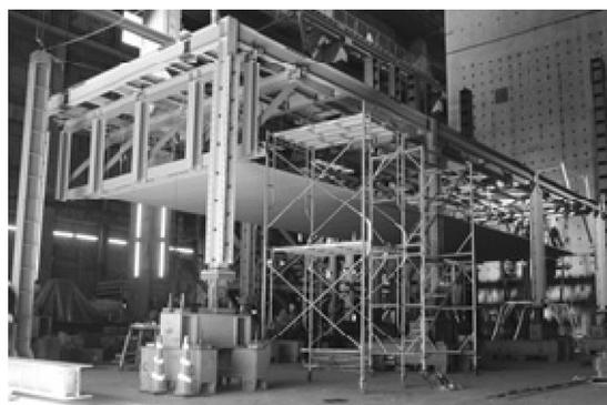
写真一2 大規模天井の加振実験
