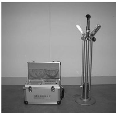
写真一 衝撃加速度試験機
