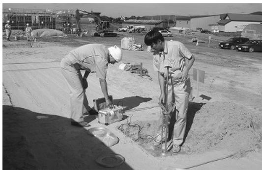
写真二 衝撃加速度測定状況
