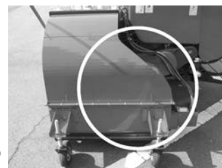
写真—7 集草装置の外形構造
