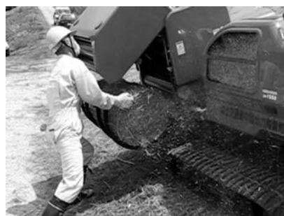
写真—11 梱包が完了した刈草取り出し状況
