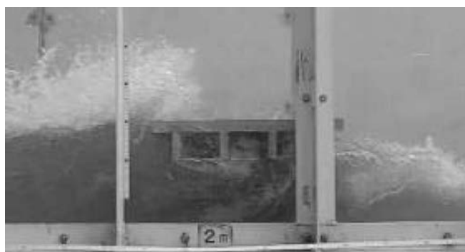
写真—3 橋の挙動メカニズムを解明するための津波実験
