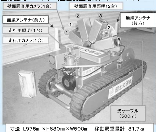
○トンネル無人点検調査ユニット(北陸地方整備局)
