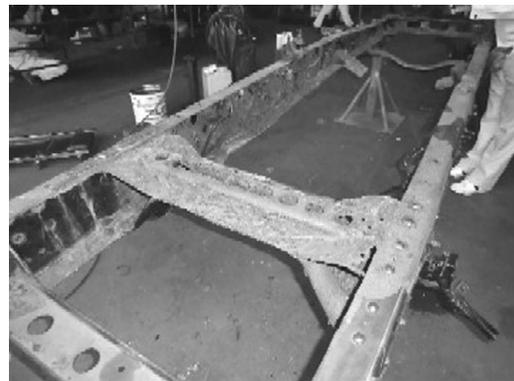
写真 1 凍結防止剤散布車のシャーシフレームの腐食
