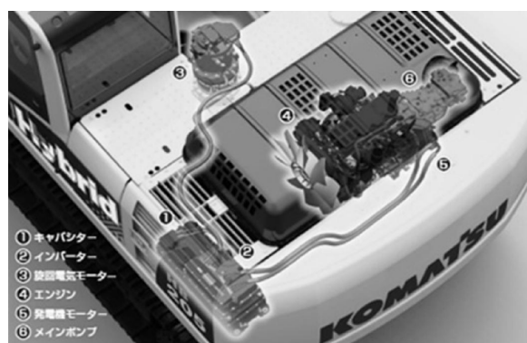
図—2 ハイブリッドコンポーネント搭載概要
