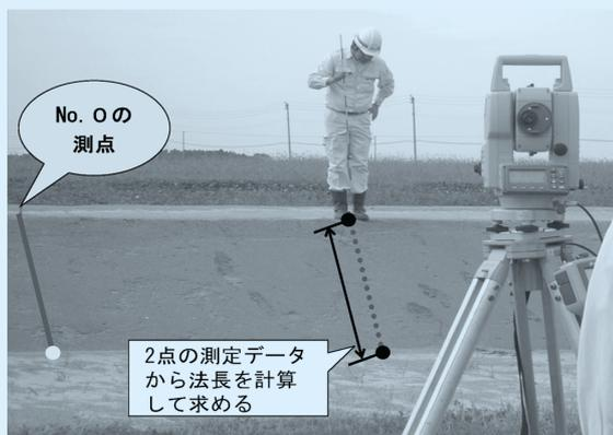
図 1 TSを用いた計測状況
