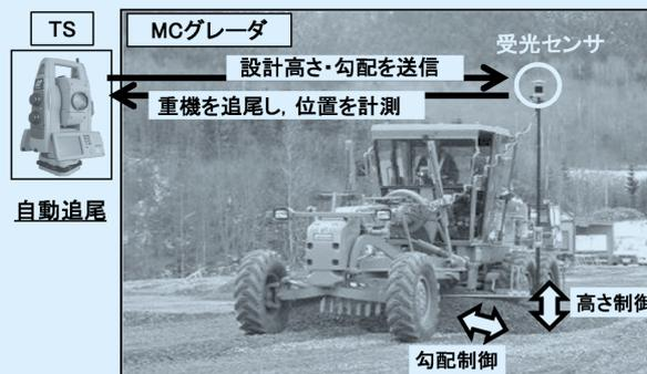
図 3 MCグレーダ施工状況
