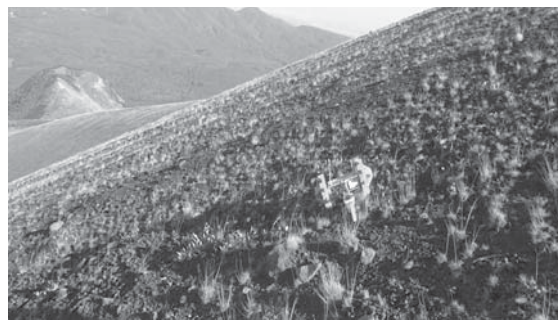
写真-4 小型移動ロボットの遠隔操作試験
