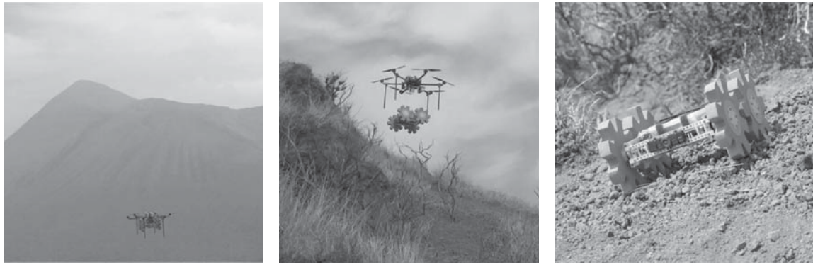
写真一5 飛行ロボットによる小型移動ロボットの運搬（左），投下（中），遠隔走行試験（右）
