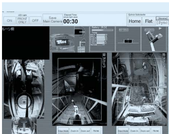
図一4 Quinceによる原子炉建屋探査の操作画面
