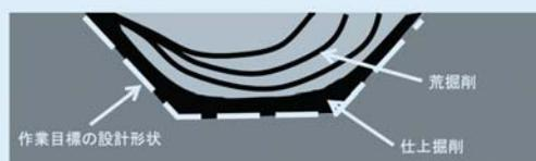
図—1 掘削動作の種類（イメージ）
