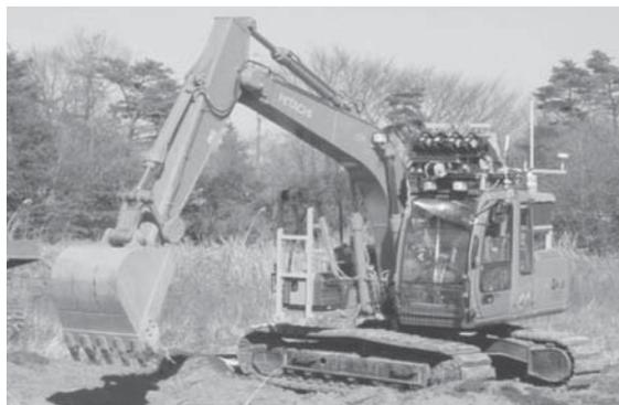
写真-1 開発技術を実装した自律型バックホウ
