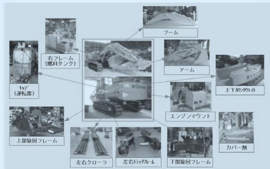
ヘリコプターによる空輸に対応するため、1ブロック当たりの最大質量が2,800kg以下に分解可能
