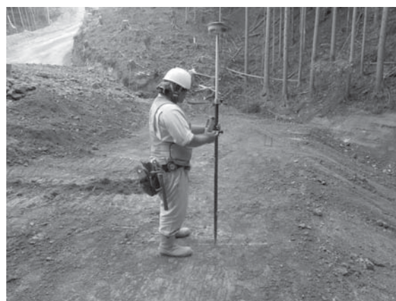
写真一六 測位中のRTKローバ
