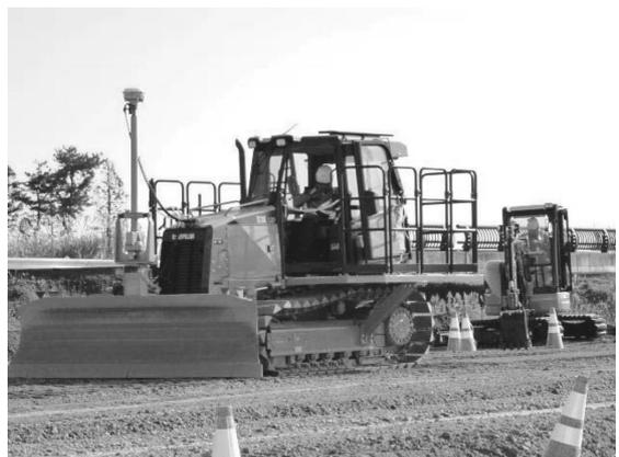
写真 3 実機体験用の3D MCブルドーザ
