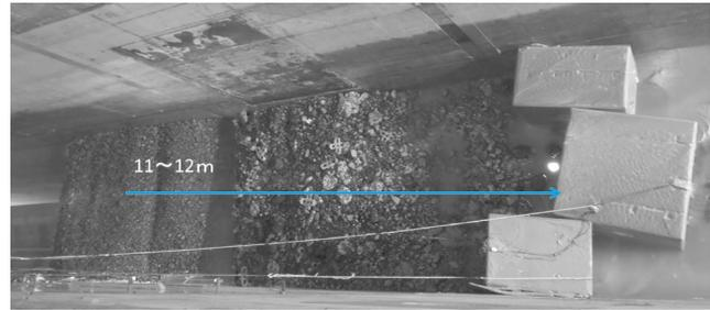
写真 2 防波堤の水利模型実験
