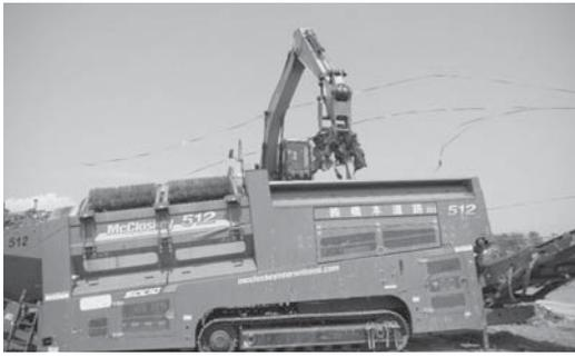
写真一11 トロンメルによる土砂抜き
