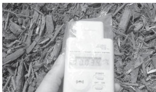
写真—10 仮置き場での放射線量測定
