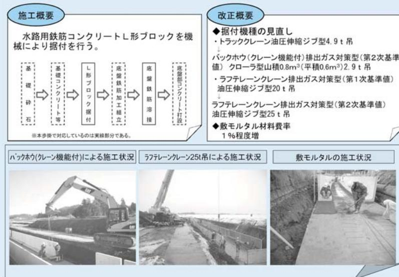
図一 3 水路用鉄筋コンクリートL形ブロック機械据付
