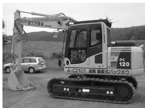
写真 1 遠隔操縦式バックホウ（0.5m 3 級）
