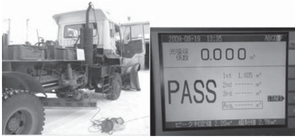
写真一5 粒子状物質 (PM) 測定試験
