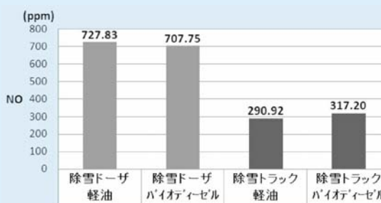
図—9 排出ガスNO計測結果
