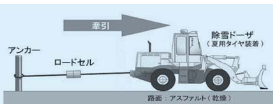
図—5 牽引力試験概要図
