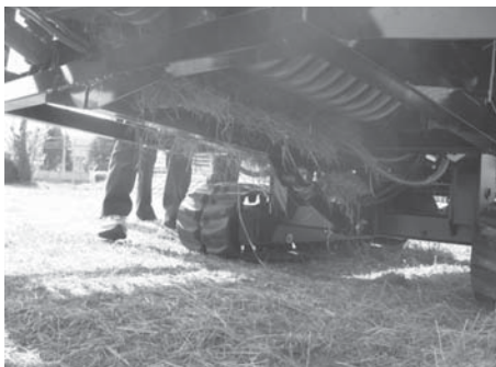
写真一12 ベルトコンベア部分の落下状況
