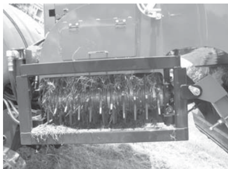
写真一11 ベルトコンベア部分の詰まり状況
