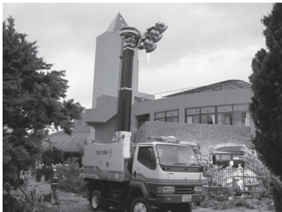
写真—3 照明車による夜間照明
