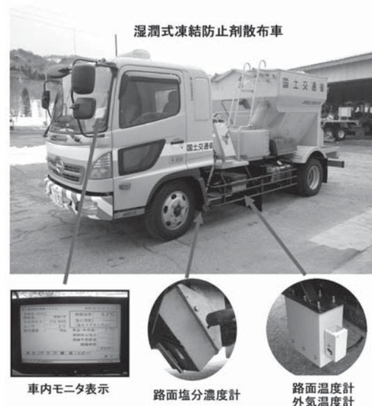
図-1 データ収集装置取り付け状況
