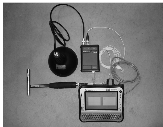
写真-14 健コン診断ポータブル機器一式
