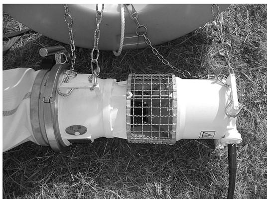
写真 6 軽量型排水ポンプ（5 m<sup>3</sup>/minタイプ）
