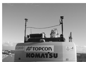
GNSS受信機×2台（上部旋回体）
