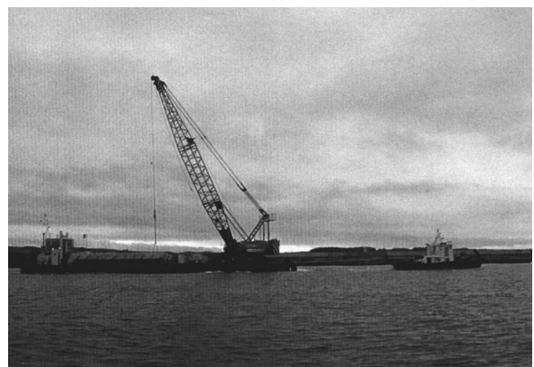
写真 4 作業船運搬状況・クレーン付き台船
