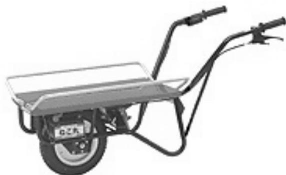
からベルトコンベアまでの運搬などには, 一輪車が使用されている。土砂運搬の効率化や作業員の高齢化などを考慮し, 電動一輪車の導入効果や問題点を把握するために現場で試用して作業員の意見をモニタリングした。
